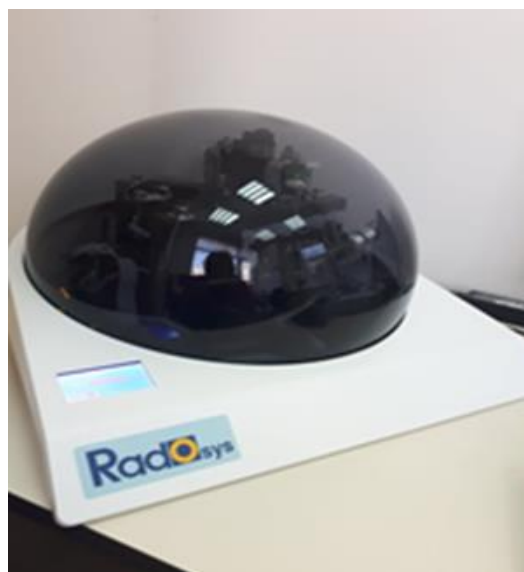
Снимка 6. Микроскоп за четене на трековете на детекторите от RADOSYS система
