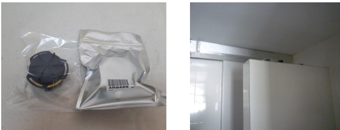
Фигура 12: Детектори с RSW камери за измерване на ОАР – ляво и поставени детектори в помещение с душове - дясно.
