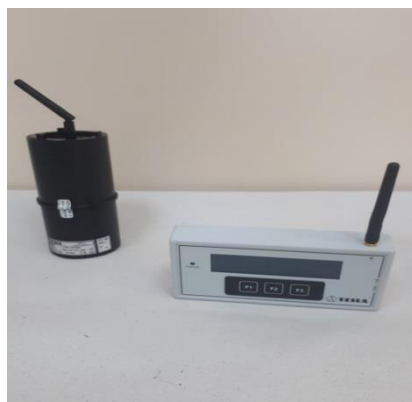
Фигура 14: TSR3D система за директни измервания на ОАР във въздух
