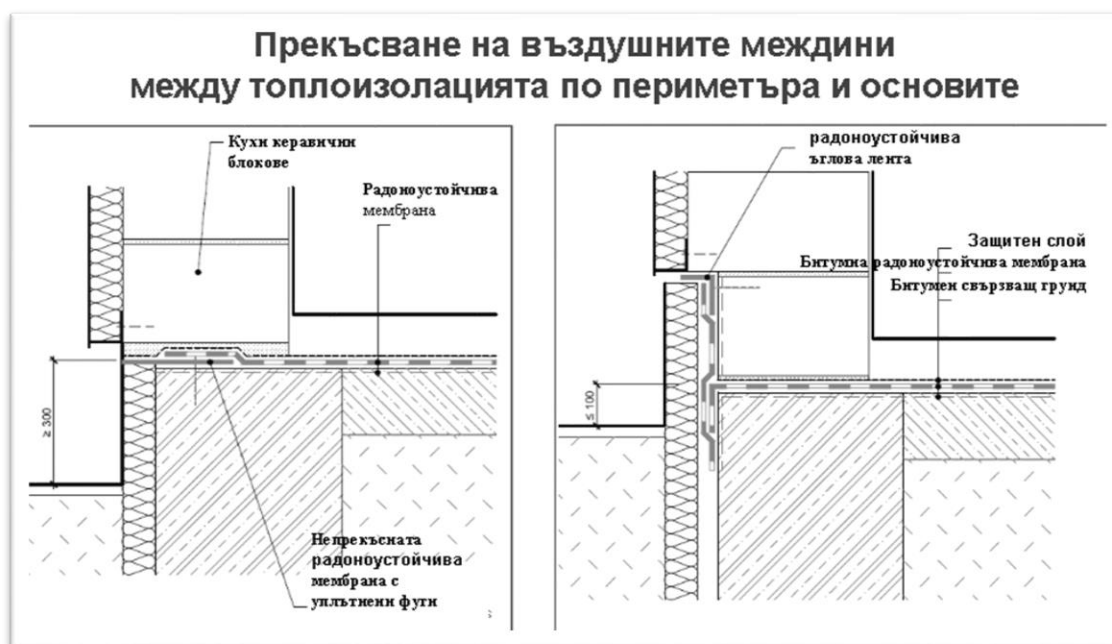
Фиг. 2.1. Прекъсване на въздушните прослойки между топлинната изолация по периметъра и основите на сграда
