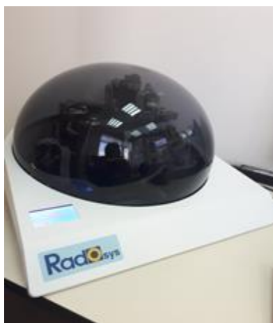
Снимка 5 Микроскоп за четене на трекове на RADOSYS система
